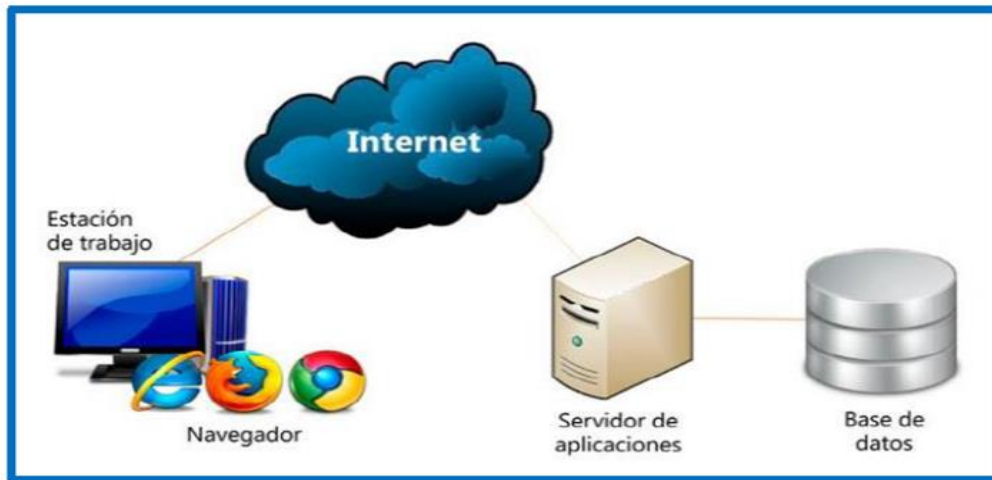
Fig 1. Funcionamiento de una aplicación web y sus componentes Fuente:(Neosoft, 2018)
