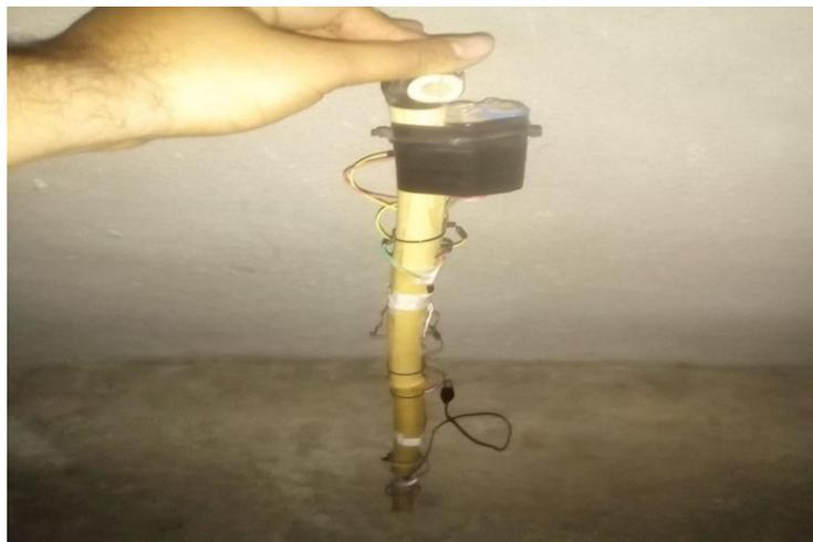
Figura 2. Prototipo bastón electrónico con materiales reciclados.
