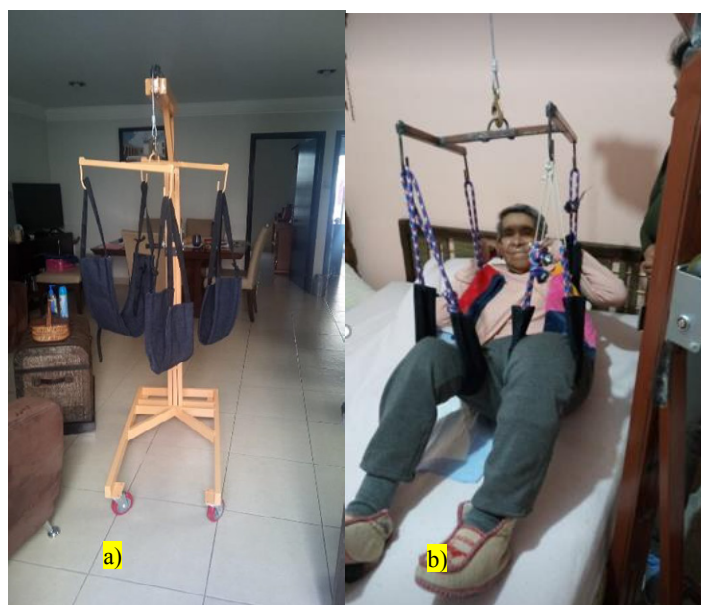
Fig. 4. Fotografía del vehículo grúa para el desplazamiento de adultos mayores a) y el mismo dispositivo con el paciente adulto con discapacidad motriz b).
