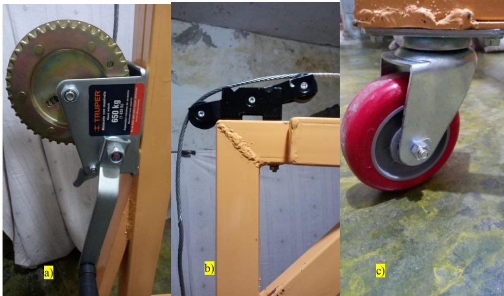
**Fig. 2. Detalle del malacate a), el tipo de poleas dobles b) y las ruedas c) utilizadas en el vehículo grúa para el manejo y desplazamiento de adultos mayores con discapacidad motriz. Fuente: Elaboración propia**
