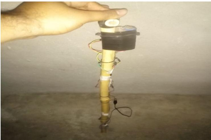
Figura 3. Prototipo bastón electrónico
